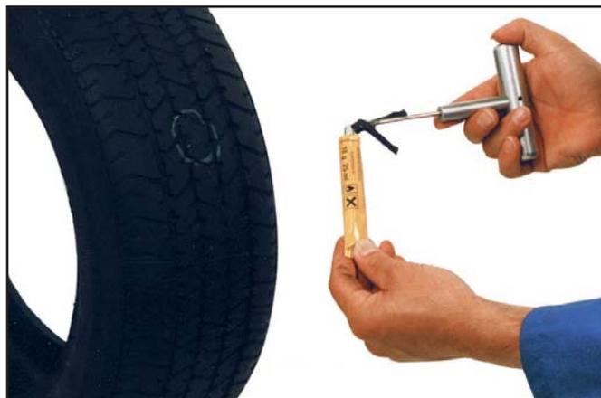
5. Ремонтный стержень до середины протянуть через ушко вводного шила. У ремонтного стержня для радиальных шин автомобилей с максимальной скоростью движения более 210 км/ч предварительно снять красную пленку. Внимание! Не допускать малейшего загрязнения ремонтного стержня!
