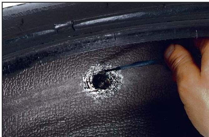
9. Нанести на внутреннюю поверхность шины вулканизирующую жидкость и прим. 3 см вокруг ремонтного стержня
