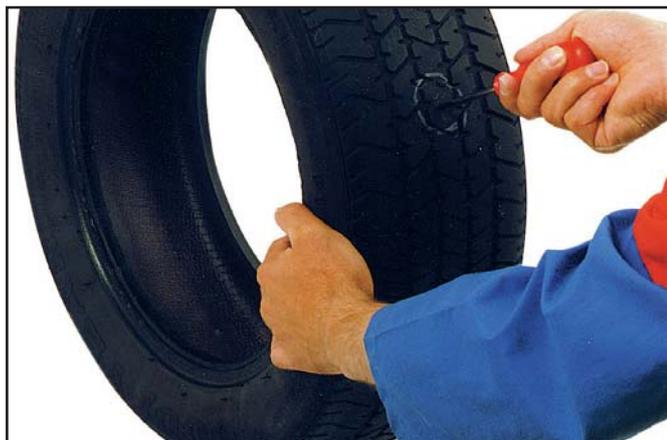
1. Демонтировать шину. Удалить предмет, вызвавший прокол шины. Проверить расширение повреждения. Оно не должно превышать 6 мм у радиальных шин автомобилей с максимальной скоростью до 210 км/ч и у радиальных шин автомобилей с максимальной скоростью движения более 210 км/ч 3мм (измерять внутри).
