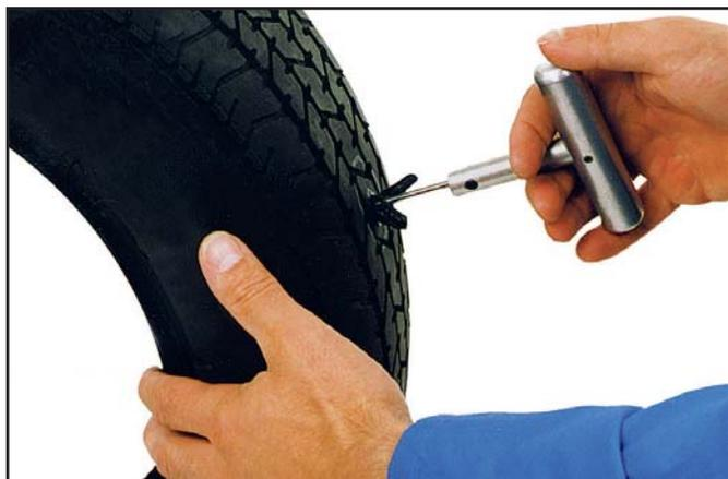
7. Нажимая вводить шило в отверстие до тех пор, пока на наружной стороне шины не останется еще прим. 10 мм ремонтного стержня, затем под давлением повернуть шило на 90 °С.
